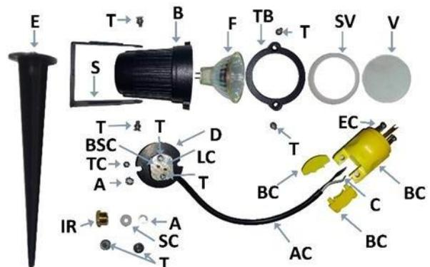
Fig. 5. Diagrama en explosión de las partes de la luminaria para exterior. Fuente: Elaboración Propia
