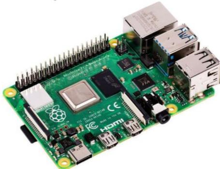
Fig. 3. Raspberry pi 4 modelo B
